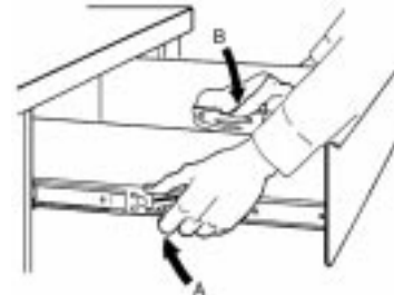
Trin 3: For udtagning af skuffen løftes i A og B presses ned.
