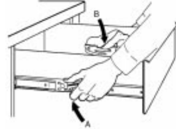
Vaihe 3: Laatikon poistamiseksi nosta pidin A ja paina alas pidin B
