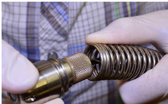
5. Накручивайте пружину на камеру, пока конец пружины не окажется заподлицо с головкой камеры.
