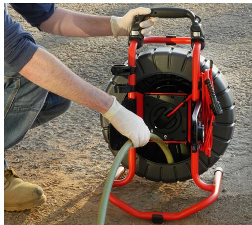
**УВЕДОМЛЕНИЕ** Вода под высоким давлением может повредить герметическую изоляцию, защищающую электронику внутри барабана.
