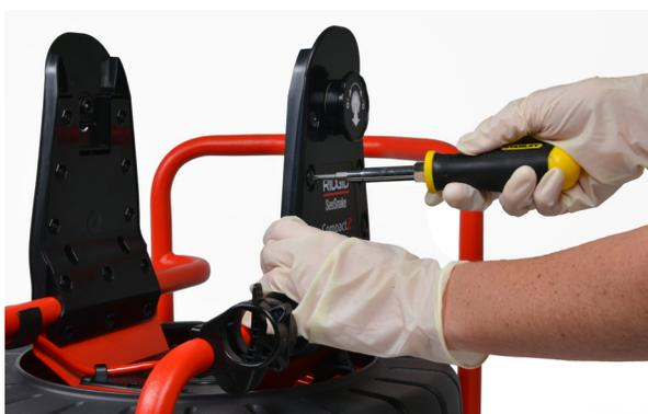
2. Раздвиньте пластины панелей и снимите их с рамы.
