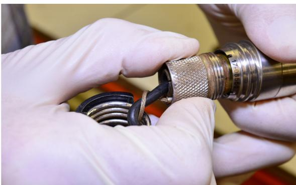
4. Когда камеру вкручивают в пружину, зонд крутится. Поверните камеру на 1 оборот против часовой стрелки, чтобы нейтрализовать это вращение, а затем вставьте в пружину.
