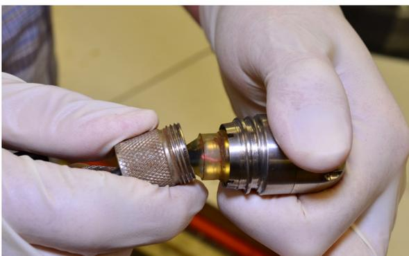
3. Чтобы ограничительные тросы не перекручивались, когда камеру вкручивают в пружину, поверните камеру назад примерно на 1½ поворота против часовой стрелки.
