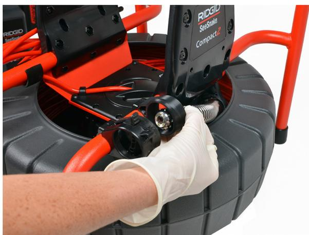
4. Верните пружинный зажим в рабочее положение, чтобы зафиксировать пружину и предотвратить втягивание проталкивающего кабеля назад в барабан.
