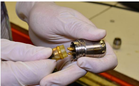
2. Сдвиньте стопорную втулку проталкивающего кабеля на камеру.
