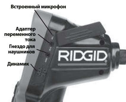
Рис. 3 - Крышка гнезд с правой стороны прибора
